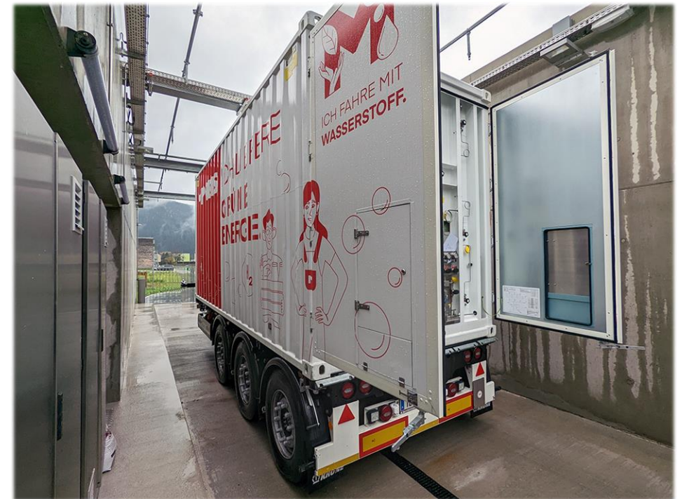
MEGC in der Befüll- / Entnahmestelle
